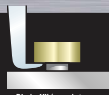
Pied effilé ou plat pour les prises délicates. Mais attention aux efforts de traction.
